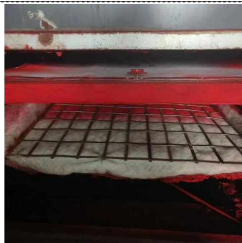
水帘+纤维过滤棉+活性炭+3 根（1#和 3#排气筒高 15m，2#排气筒高 16m）排气筒
